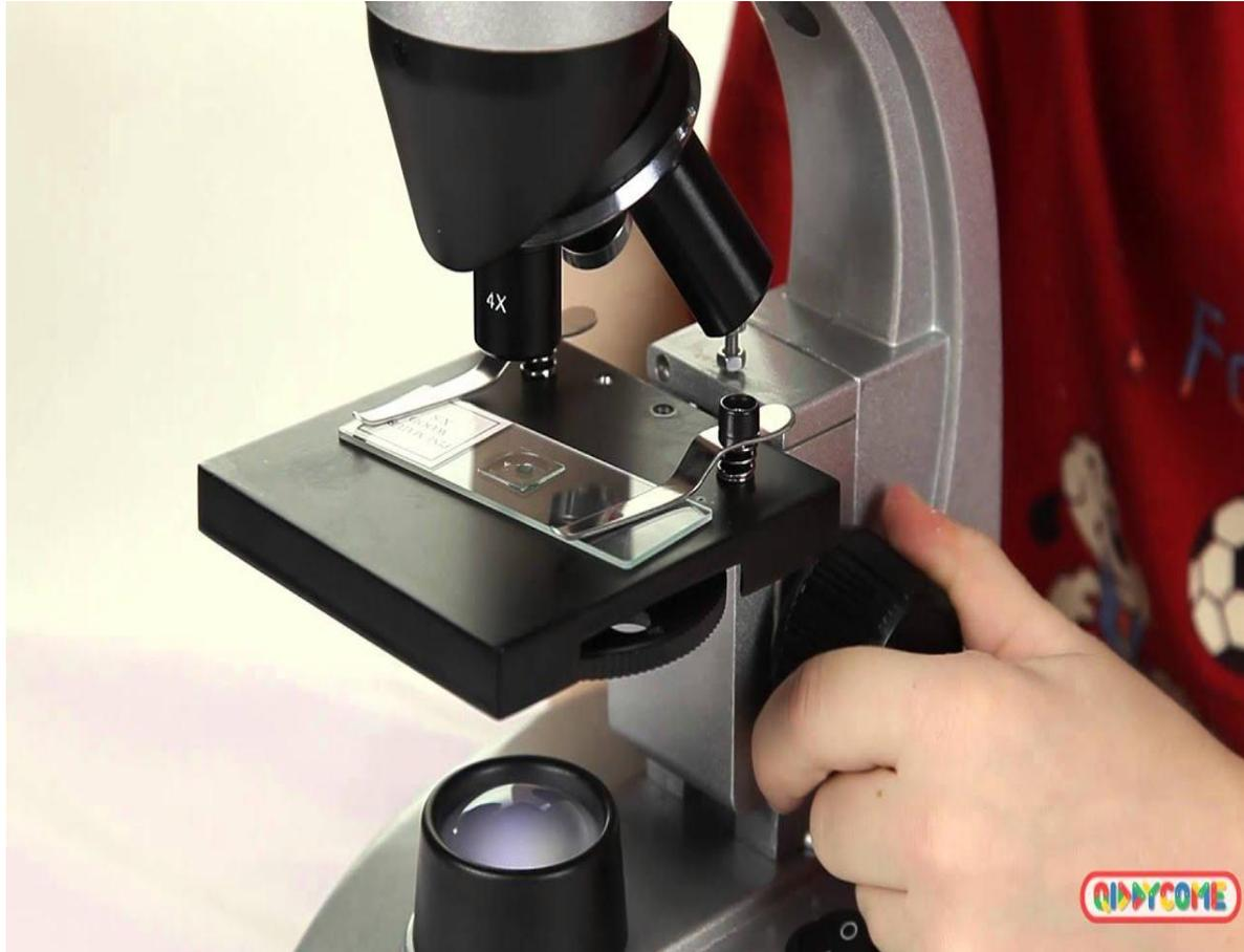
✓Предметный столик относится к механической части микроскопа
